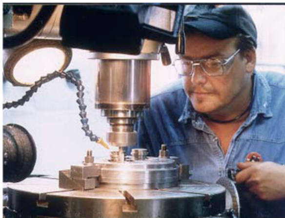
Fabrication d'une filière, Sapa, Suède
